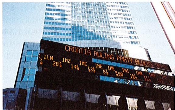
図 1. InGaAlP LED ランプを使用した屋外 LED パネル InGaAlP 系の黄色発光の超高輝度 LED ランプを使用した大型の屋外 LED パネル。
