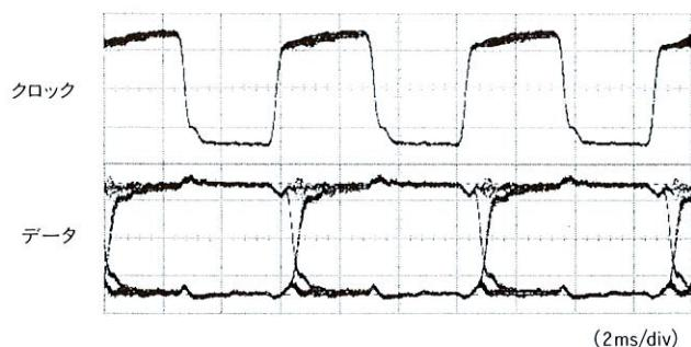
図9. 光受信モジュールの出力波形 2.5 Gbps の光信号を受信し 16 ビットに分割された 155 Mbps の出力波形とクロック。
