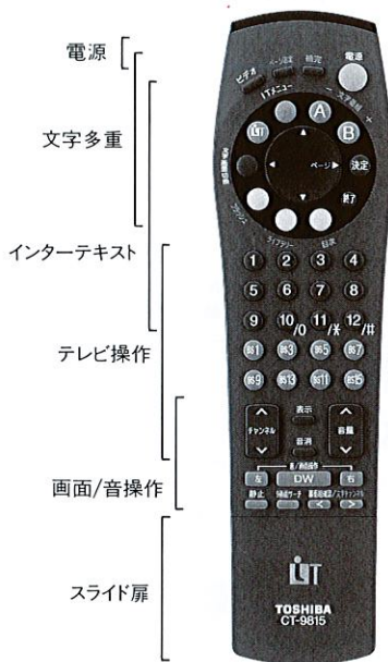
図2. リモコン 機能と情報の流れに整合させたキーレイアウト。 Remote controller
