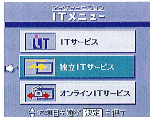
図4. メニュー選択画面 主放送の番組と連動したITサービス、番組とは連動しない独立ITサービス、電話回線を通して行われるオンラインITサービスが選択できる。
