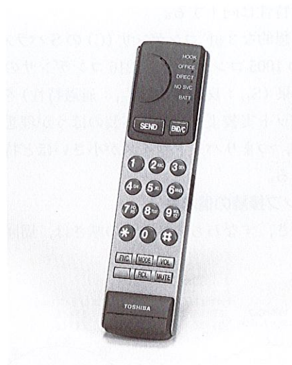
図 1. 超小型 PHS 端末 容積 60 cm 3 , 重さ 85 g, 縦 140 mm×横 35 mm×厚さ 15 mm (最大部) の超小型 PHS 端末。 Ultracompact PHS terminal
