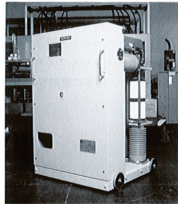
図7. 新型多頻度型 VCB 定格：24 kV-1,250/2,000 A-20 kA, 36 kV-1,250/2,000 A-12.5 kA。
