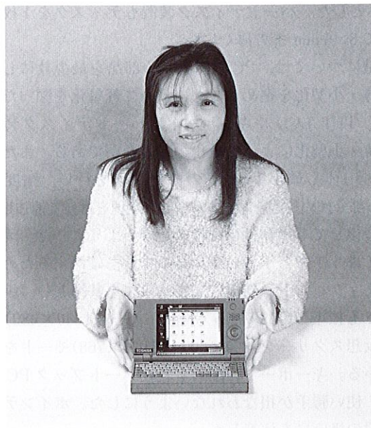
図1. 超小型携帯PC “Libretto” Windows ® 95を搭載し、手軽に持ち歩ける超小型携帯PC。
