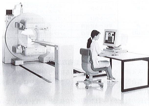
図1. 二検出器型ガンマカメラ 高画質の全身像が得られる核医学診断装置。装置のほとんどのカバー部分にリサイクル容易な板金カバーを用いている。
