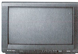
図 7. 省エネルギー型テレビ 負荷電力削減、電源効率改善などにより、1995 年度商品は前年比約 17 % の年間消費電力量の低減を達成した。
