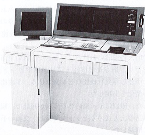
図 1. 定期券発行機 ES-1500 駅名入力部に 10.4 型のタッチキー付きカラー液晶ディスプレイを 2 画面採用し、操作性と小型化を実現した。
