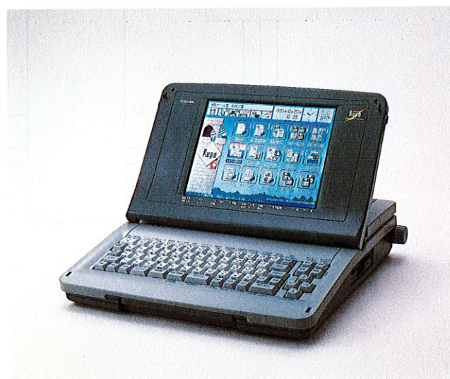
図 2. カラーワープロ JW-V600 動的輪郭モデルを用いて対象物を抽出する機能をもつ。
