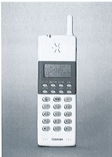
図 12. デジタルコードレス電話 業界初採用のデジタルコードレス電話。処理場内の内線を移動通信可能とした。
