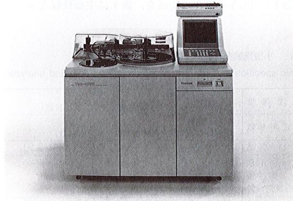
図1. 小型自動分析装置 TBA-40FR データ処理部を一体化したコンパクトな設計になっている。
