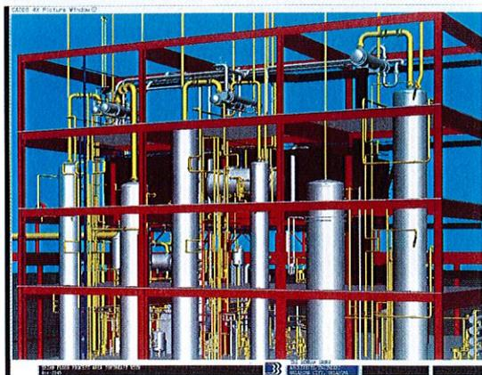
図9. プラント設計 フローシートの作成からプロットプラン、レイアウト設計、詳細レイアウト、そして部品リストの作成、スプール図の自動生成など一連のプラント設計の作業が可能。
