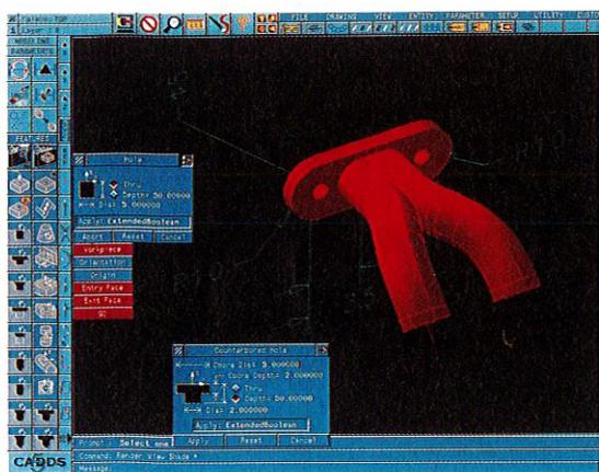
図6. フィーチャベースモデリング オブジェクトにユニットを非図形属性として付加している。
