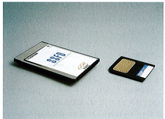
ドライバ部分(左)とフラッシュメモリ部分(右)とを分離・持ち運びできるハンディメモリカード Handy memory card driver (left), and flash memory card (right)
