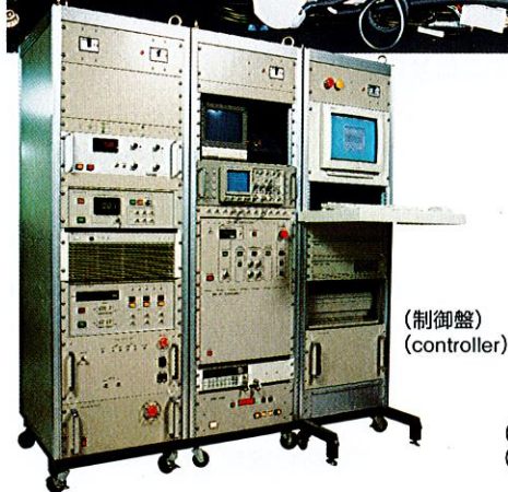
DVD用原盤記録装置 Mastering machine for DVD
