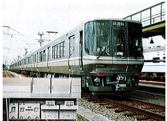
223系通勤・近郊電車とデュアルモード式個別制御VVVF/CVCFシステム Series 223, and dual-mode individual-axle-control type VVVF/CVCF system
