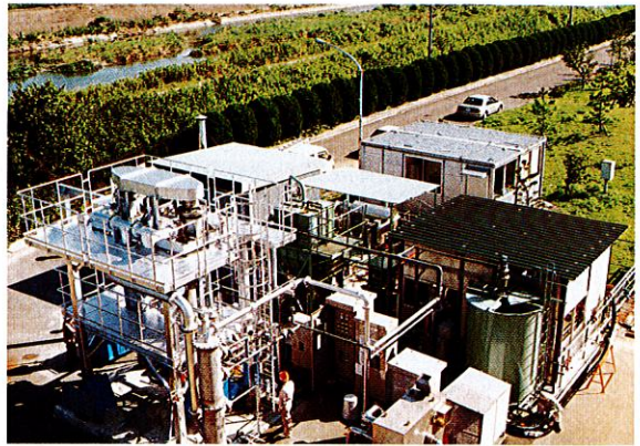
下水処理場向け大型遠心薄膜乾燥機 Centrifugal sludge dryer
