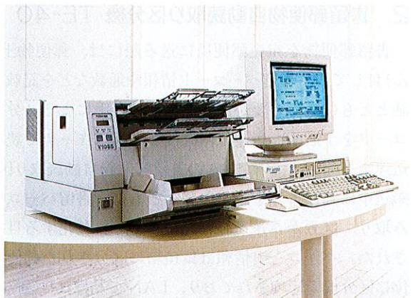
光学的文字・マーク読取装置 OCR-V1035
