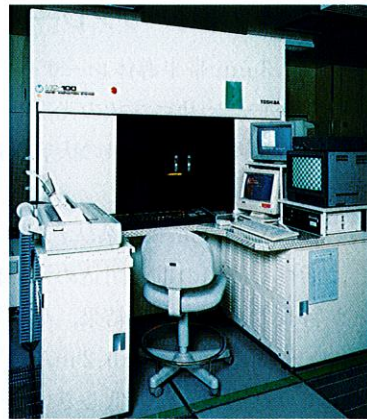
マスク欠陥検査装置 MC-100 MC-100 mask defect inspection system
