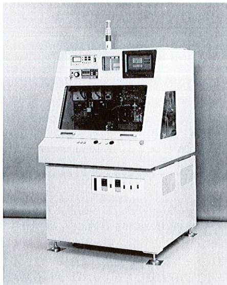
図1. 開発したフリップチップボンダ 半導体チップと基板の電極を高精度に位置合わせして接合する装置である。
