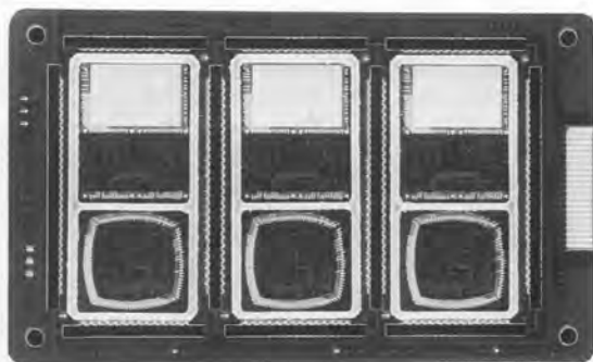
図5. コンビネーション B 2 it TM 基板の試作例 ベアチップを2個搭載するマルチチップモジュール用基板の例で, 端子は銅スルーホールメッキ法を利用した QFN 構造である。
