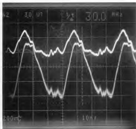
図 4. 30 MHz (1 出力) の出力波形 30 MHz でも十分な信号期間が得られる。
