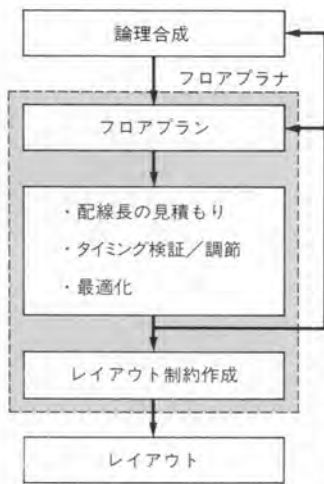
図5. フロアプラナ概念 フロア プランツールを使った場合の設計フ ロー。精度の高いシステム設計がで き、開発期間を短縮できる。 Design flow using floor plan tool
