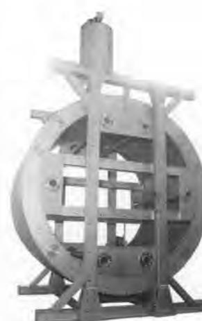
図6. 大型間接冷却超電導マグネット 薄肉内巻を特徴とした、大型粒子検出器用超電導マグネット。
