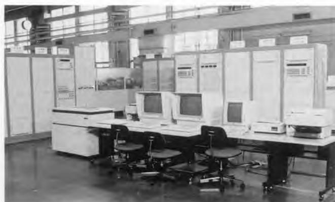
図3. 電力系統シミュレータ 電力系統の現象を忠実に模擬する電力系統シミュレータは、系統安定化システムの検証に威力を発揮する。
