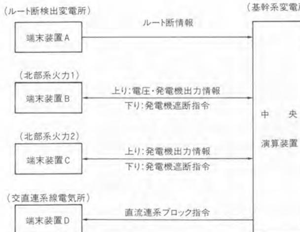
図8. 東北電力株系統安定化システムの構成 複数の端末装置から伝送されるオンラインデータに基づいて中央演算装置で安定化演算を行い制御指令を出す。
