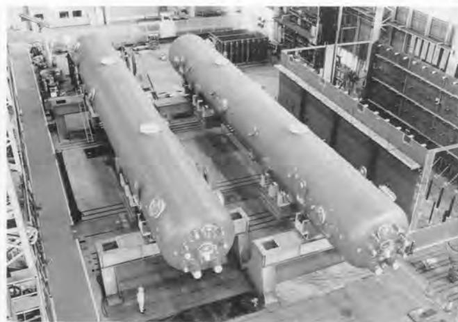
図1. 湿分分離加熱器(MSH) MSHは胴外径3.6m、全長30m、重量280tで2体からなり、プラント熱効率向上のために初めて採用した。
