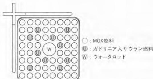
図5. 1,100MWe級BWRプラント用MOX燃料設計例 ガドリニア入り燃料棒以外をMOX燃料棒として集合体当たりのプルトニウム量を多くする。
