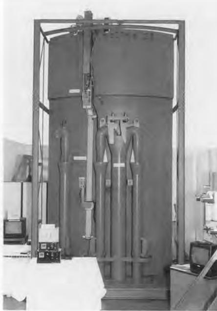
図5. シュラウド外胴つり式 UT 装置 シュラウド上端部からつり下げて溶接線近傍の超音波検査を行う装置である。
