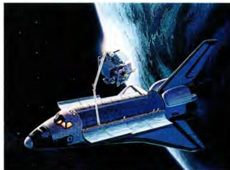
図5. SFU 回収時の予想図 スペースシャトルのRMS (Remote Manipulator System) に把持されたSFU。
