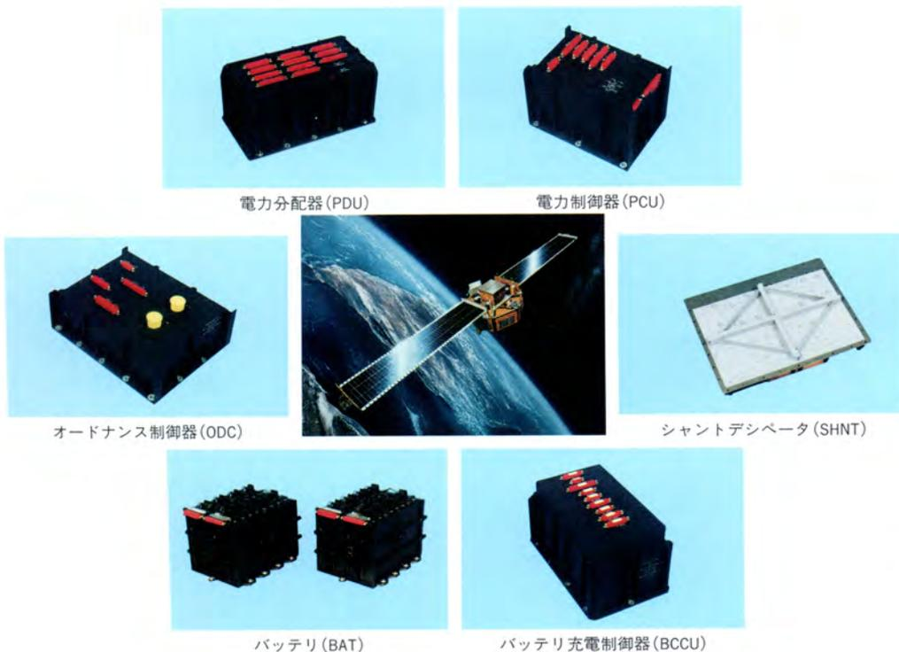
図2. EPSの構成 EPSコンポーネントは、BSU (BuS Unit) -1, -2と呼ばれるユニットボックスに分割して搭載されている。
