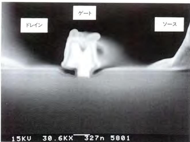
図2. H-FETの断面SEM写真 電子ビーム直接描画方法を用いてゲート長 $0.3\mu\text{m}$ のゲート電極をリセス内でソース側に $0.1\mu\text{m}$ オフセットして形成した。
