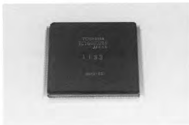
図7. パワーエレクトロニクス制御専用ゲートアレイ LSI 電動機制御に必要な機能を集約している。 External view of LSI for power - electronics control
