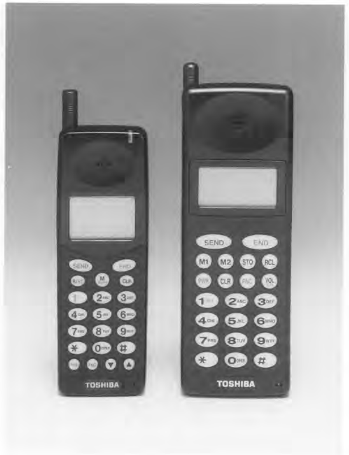
図2. 小型化デザイン 右は従来機。左の今回開発した携帯電話機は、小さくて親しみのあるデザインで人間工学的配慮をしている。
