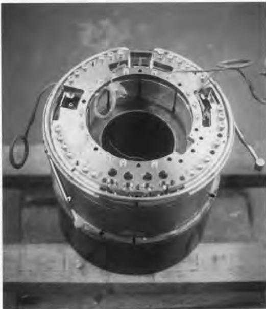
図3. ニオブチタンコイルとコイル冷却板 接触熱抵抗低減のために、ニオブチタンコイルの外周をコイル冷却板で挟んだ。
