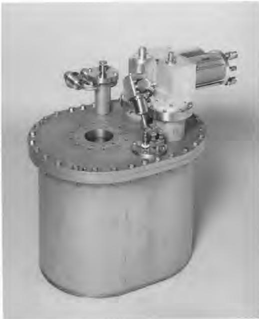
図1. 冷凍機直冷式10 T超電導磁石 極低温冷凍機だけで超電導コイルを冷却し、直径10 cmの室温空間に10 Tの高磁界が発生する。
