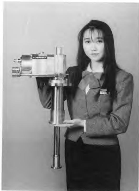
図6. 磁性蓄冷材を用いた4 K冷凍機 超電導コイルの冷却に使用した4 K冷凍機。4.2 Kにおいて500 mWの冷凍能力をもつ。
