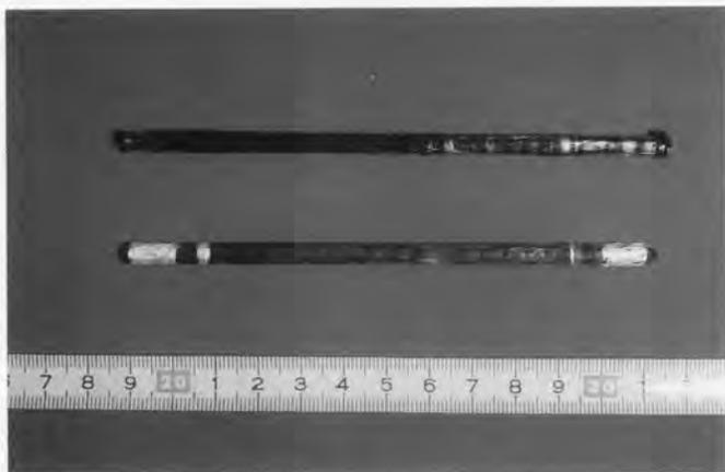
図4. 超電導電流リード レーザ溶融法で作製した Bi2212 超電導電流リードで、1,500 A 以上の通電が可能である。
