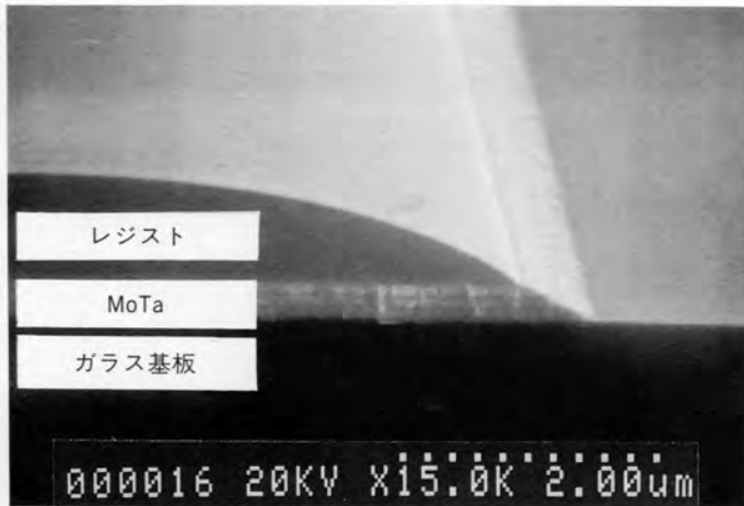
図9. エッチング後のテーパ形状の断面 マスクのレジストを後退させながらテーパ形状にエッチングする。これにより、ステップカバレッジを良くする。
