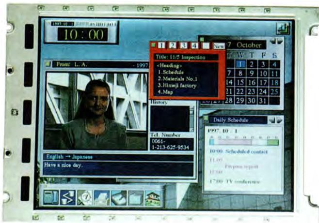
図5. TLX-8182S-C3Xの外観 800×600画素、SVGA対応のカラーSTモジュールの表示例。
