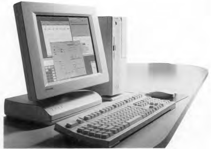
図 3. 13.8 型カラー TFT-LCD 搭載デスクトップ WS AS5080 AS5080 desktop workstation with 13.8-inch color TFT-LCD
