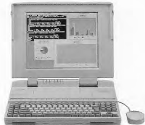
図1. 13.8型カラーTFT-LCD搭載ラップトップWS AS1000/C60, C70 AS1000/C60, C70 laptop workstation with 13.8-inch color TFT-LCD
