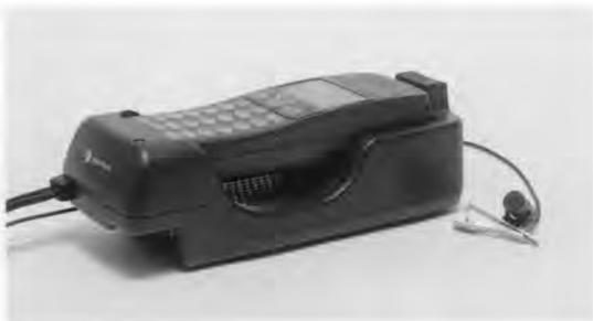
図7. オプションカーキットと携帯電話機 携帯電話機をオプションカーキットに装着すると、拡声自動車電話機として使用できる。
