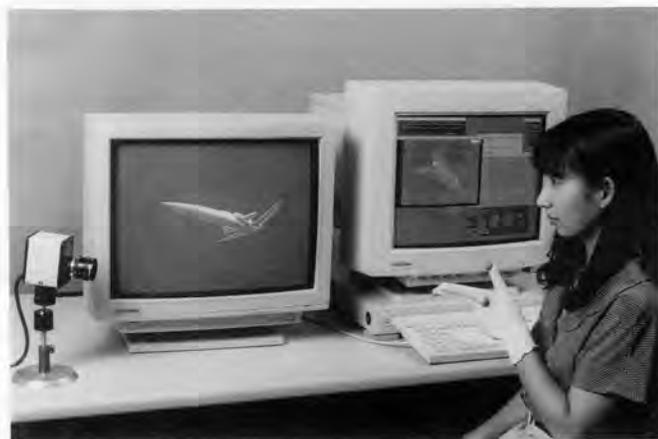
図1. 三次元空間の操作を行うヒューマンインタフェースシステム 左にあるカメラで撮影したオペレータの手の動きを解析した結果で、ディスプレイ中の飛行機を操作することができる。
