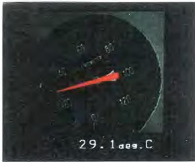
図5. アナログ計器の読み取り例 このアルゴリズムにより、日照変化にかかわらず安定して油温度計の指針値を計測することができた。
