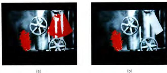
図6. 移動ベクトル法によるノイズ除去と蒸気漏れの検出結果 差分処理だけでは表示札のような正常変化も検出してしまう(a)が、移動ベクトル法によれば異常事象だけ識別できる(b)。
