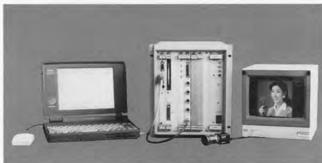
図 1. FA 用画像処理コントローラ V300 組込み電源付き 8 スロットカードラック構成と CCD カメラおよびダイナブック。
