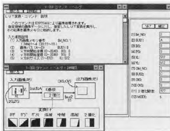
図5. ヘルプ画面 LUT 変換コマンドの機能を説明、図解している例。 Example of help display (DynaBook)
