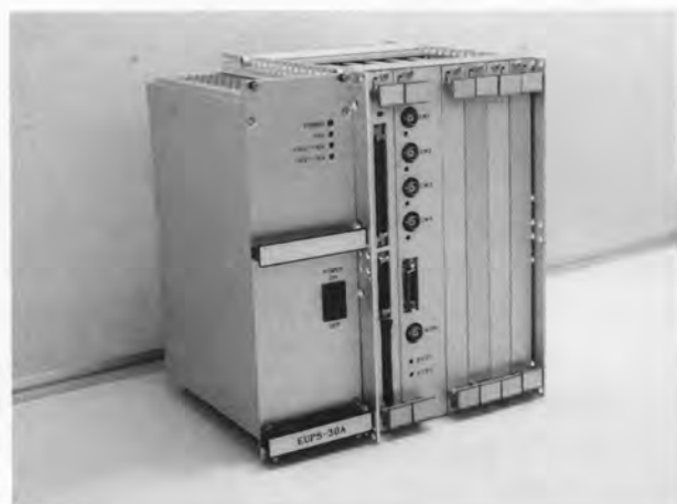
図 1. FA 画像処理装置本体 VME バスを採用し、ボードの大きさは、ダブルハイト VME ボードとなっている。
