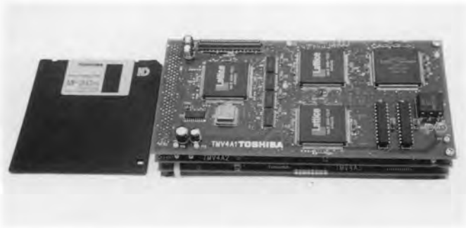
図5. ロボット用視覚装置本体 3.5インチフロッピーディスク2枚分の大きさで、3枚構成になっている。 Robot vision processor
