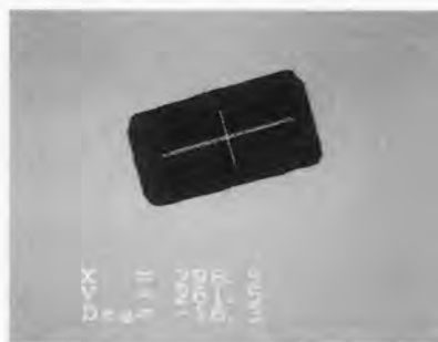
図4. チップ部品の計測例 部品中央の十字線が、中心位置と姿勢を表している。
