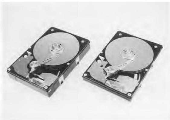
図1. 2.5 インチ型磁気ディスク装置 1.35G バイトシリーズ 19 mm 厚で 1.35 G バイト、12.7 mm 厚で 810 M バイトの装置を開発した。
