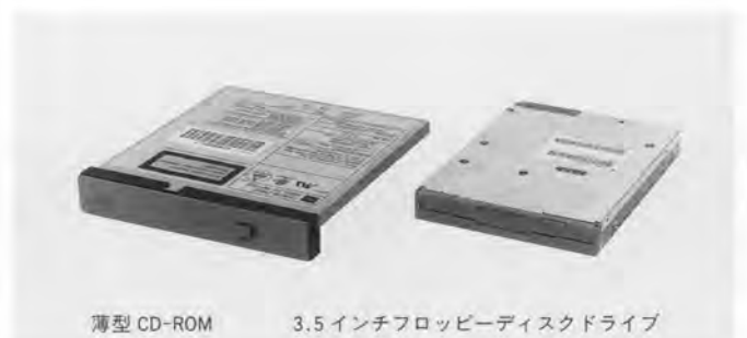
図 2. 薄型 CD-ROM FDD 並みの薄型でフルサイズ CD (12 cm) と 2 倍速に対応した高機能ドライブで、ドロワー方式を採用している。 Thin type CD-ROM drive
