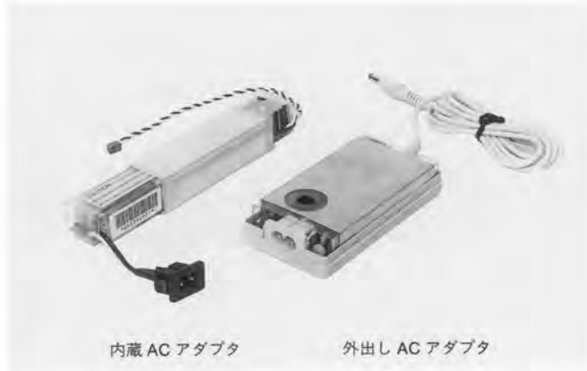
図 3. 内蔵 AC アダプタ 主要部品の小型化と実装効率の向上により容積、質量を約 30%削減した。 Integrated AC adapter
