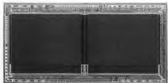
図4. 32MビットNAND型フラッシュメモリのチップ  $0.425\mu\text{m}$ の設計ルールでチップサイズは $7.04\text{mm} \times 14.69\text{mm}$ である。
