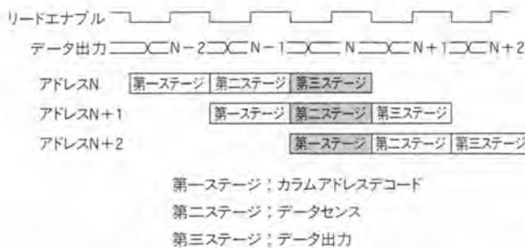
図8. バイプライン制御 3段のバイプライン制御を行いシリアルサイクルの高速化を図っている。
