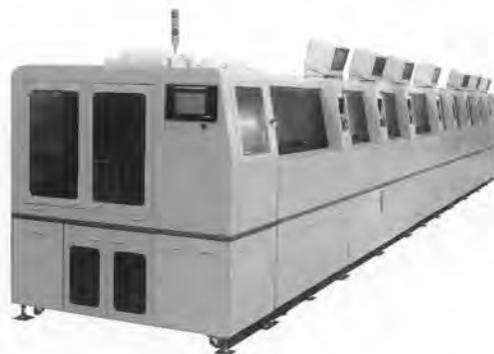
図5. 70 $\mu$ mピッチ対応液晶OLBライン 微細ピッチ接続が可能で生産性の高い新開発の液晶OLBライン。
