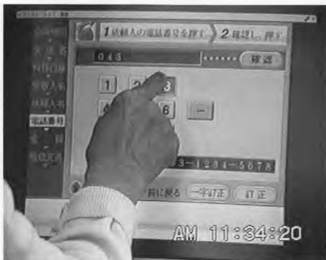
図 2. シミュレーションによる UI 評価風景 高齢者が、ATM のシミュレーション用画面を操作しているようす。記録・分析用ビデオの 1 画面。
