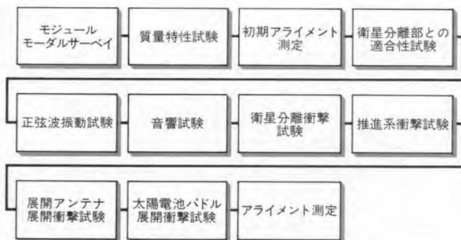
図2. STM 構造試験のフロー COMETS STM 構造試験のフローを示す。
