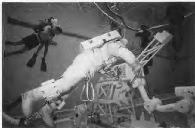
図 6. 船外活動適合性評価試験 宇宙飛行士による NASA 無重力環境訓練設備を用いた EVA 適合性評価試験状況。
