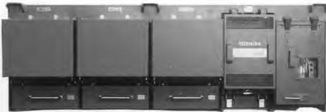
図 4. IGBT インバータ装置本体 右端が制御部、左側が IGBT ユニットの構成している。
